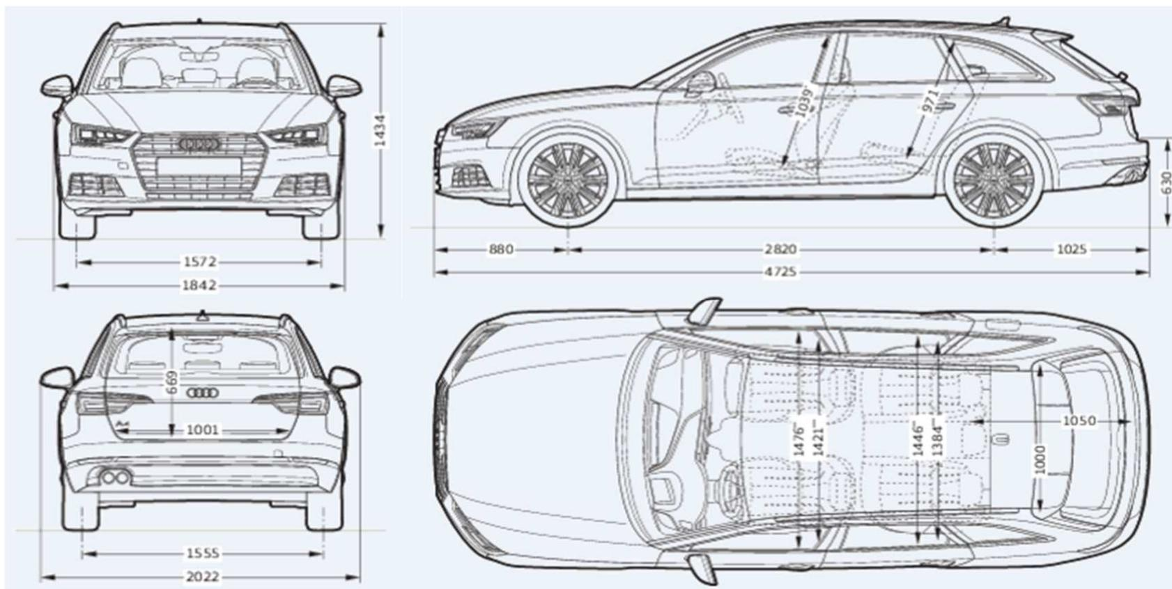
**Misure in millimetri.**
